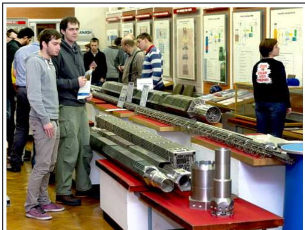
Návštěva fabričního závodu na jaderné palivo ve městě Elektrostal – informační centrum, makety palivových souborů pro reaktory VVER-1000, VVER-440, RBMK, PWR
